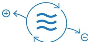
Для контроля перетока воздуха между кухней и залом применен **разный баланс вытяжки и притока**: отрицательный для кухни (вытяжка больше, чем приток), положительный для зала (приток больше, чем вытяжка).
